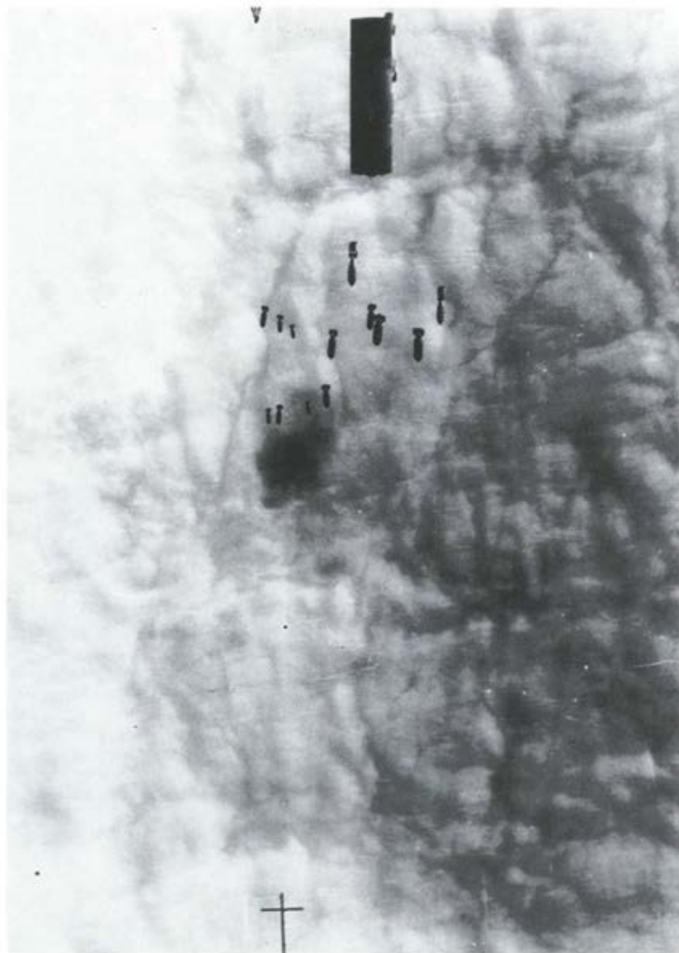
Une bombe de 4000 livres et un chargement de bombes incendiaires dans un ciel très nuageux sur Dortmund le 12 mars 1945. Un total de 1108 avions sont expédiés sur l'objectif (un record) dont 192 sont du 6 e Groupe. Le manque d'aérodynamisme du « biscuit » (et par conséquent son manque de précision inhérent) est évident dans cette photo. (PL 144267)
