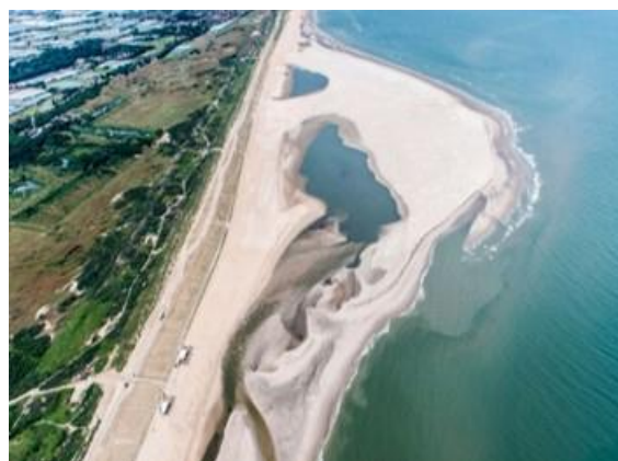
Figure 20. Important rechargement de sable sur la côte de Delfland, au Pays-Bas.
